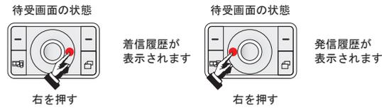
●着信履歴を表示中に を押すと、不在着信履歴が表示されます。
